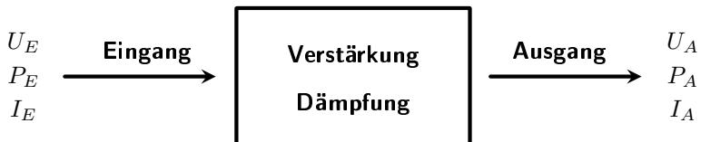
**Verstärkung**<sup>1</sup> liegt dann vor, wenn das Ausgangssignal größer als das Eingangssignal ist.
